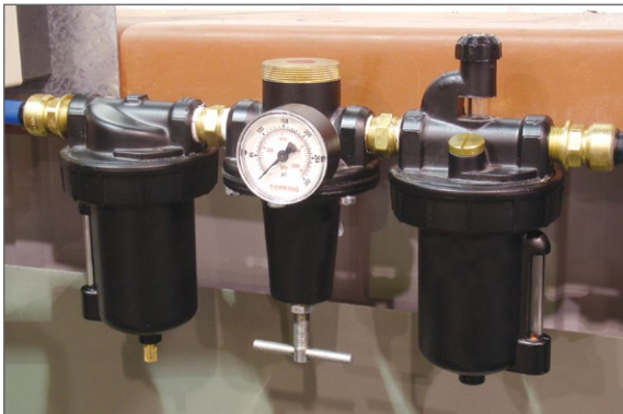
Les FRL de type standard se connectent à l'aide de raccords de laiton
